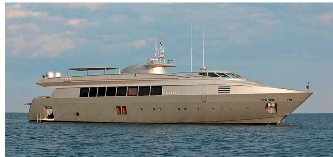
En 1998, le moderniste Blue Ice sort des chantiers Baglietto. C'est l'un des tout premiers yachts «wide body». La superstructure se confond avec la coque. Les passavants ont été supprimés. Le yacht le plus radical de la fin du siècle !
